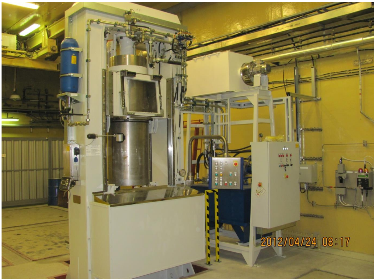
D.2.4 – 2. ábra Hulladéktömörítő prés
