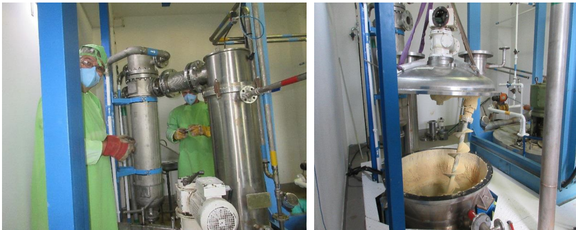
M.7.3 – 4. ábra: Uránkoncentrátum szárító
